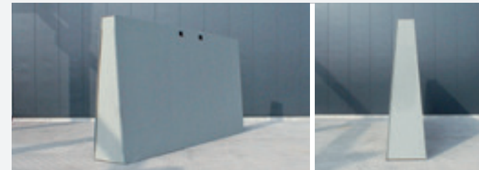
Trennwand - Form: beidseitig schräg. Zur flexiblen Erstellung von Boxen bzw. der Trennung von Schüttgütern. Besitzt ausgezeichnete Gewichts- und Kraftverteilung zwischen dem in die Wand eingelassenen Füllgut und dem anliegenden Schüttgut.
